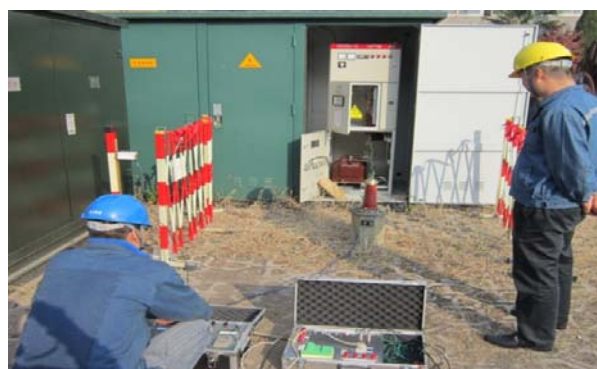
图 31 2014-10-11 江苏武进不锈钢有限公司 10kV 箱变电气试验现场
