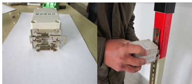
图 15 卡座正面 图 16 在导轨上下调整
